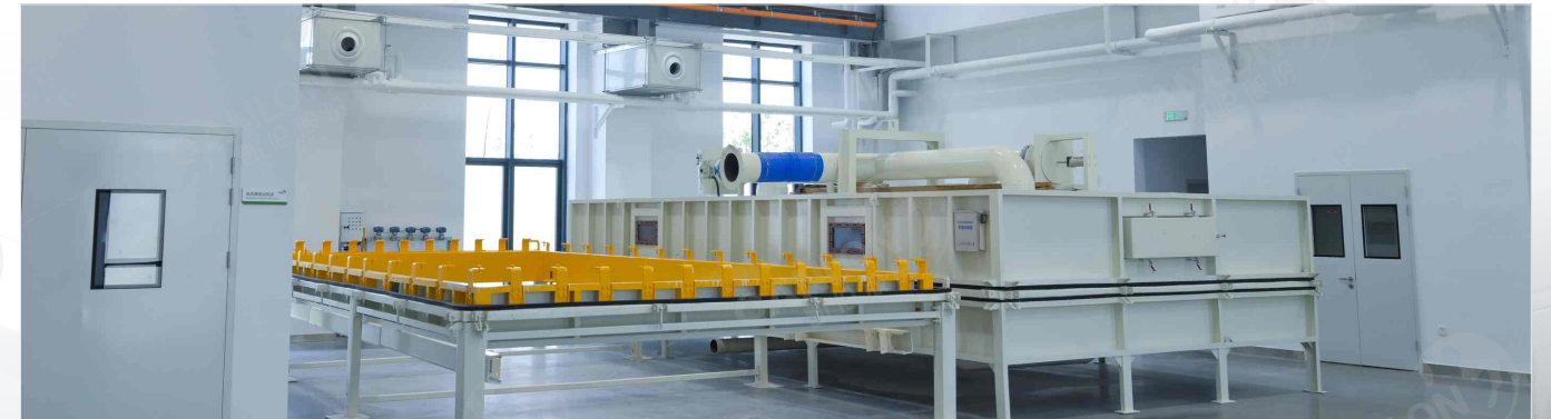
屋面系统水密、气密、抗风压性能检测设备
